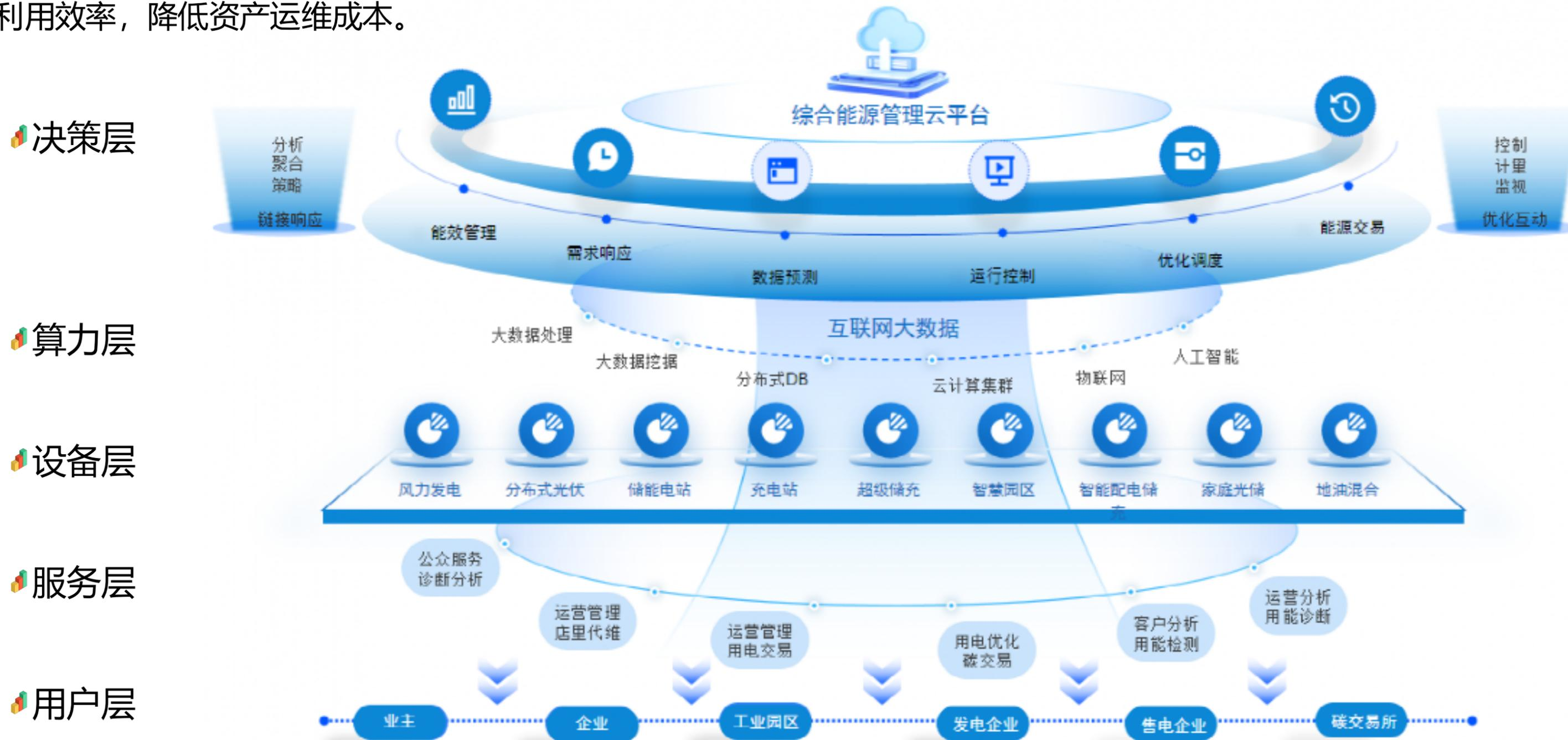
EMS (Energy Management System, 能量管理系统), 是储能系统的整体决策系统, 储能EMS有电网级和微网级
